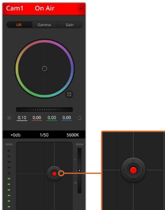
Когда сигнал камеры выводится в эфир, кнопка управления диафрагмой/уровнем черного становится красной
