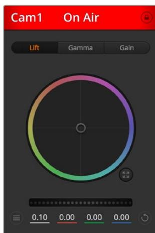
В каждом окне управления отображается строка состояния, поэтому режиссер всегда знает, какое изображение передается в эфир. Цветовые круги позволяют по отдельности менять параметры тени, полутона и света для каждого канала, используемого в YRGB-обработке.
