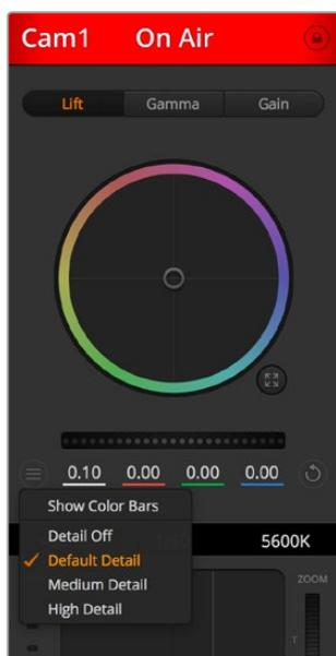
Кнопка настроек камеры позволяет включать или отключать функцию цветных полос, а также изменять резкость изображения на камерах Blackmagic
