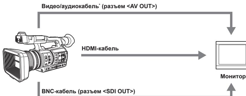
\* Используйте приобретаемый отдельно видео/аудиокабель (4-полюсный мини-штекер). Проверьте характеристики проводов 4-полюсного мини-штекера.
