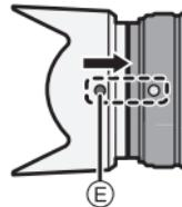
**2 Tournez le parasoleil dans le sens de la flèche jusqu'à ce qu'il s'arrête, et alignez le repère d'arrêt (F) sur le côté long du parasoleil avec le repère à l'extrémité de l'objectif.**
