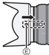
2 Gire la visera de la lente en la dirección de la flecha hasta que se detenga y alinee la marca de tope **F** en el lado largo de la visera de la lente con la marca en la punta de la lente.
