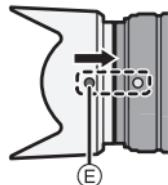
**2 Поверните бленду объектива до полной остановки в направлении, указанном стрелкой. При этом метка остановки на длинной стороне бленды объектива (F) должна совпадать с меткой с края объектива.**
