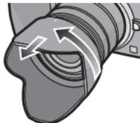
**2 Drehen Sie die Gegenlichtblende um und setzen Sie sie wie oben beschrieben wieder auf.**
