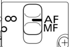
Для съемки в режиме автоматической фокусировки (AF) установите переключатель режимов фокусировки в положение AF. Чтобы использовать ручную фокусировку (MF), установите переключатель режимов фокусировки в положение MF и настройте фокусировку, поворачивая фокусировочное кольцо. Фокусировочное кольцо функционирует всегда, независимо от установленного режима фокусировки.
