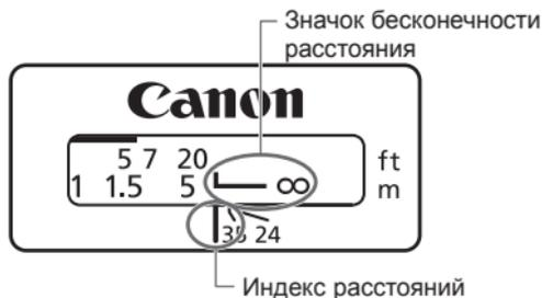
Предназначен для компенсации смещения фокусной точки в бесконечности, вызванного перепадами в температуре. Точка бесконечности в условиях нормальной температуры - это точка, в которой вертикальная линия знака L на шкале расстояний совпадает с индексом расстояний.
