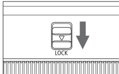
**2** Передвиньте рычаг фиксатора кольца зумирования в направлении стрелки.
