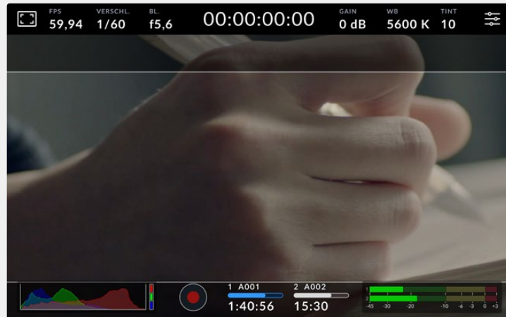
LCD-Touchscreen mit aktivierten 2,40:1-Bildrandmarkierungen
