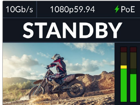
電源とビデオが接続されると「PoE」インジケータが緑に点灯し、直後にビデオの映像と「STANDBY」インジケータが表示されます
