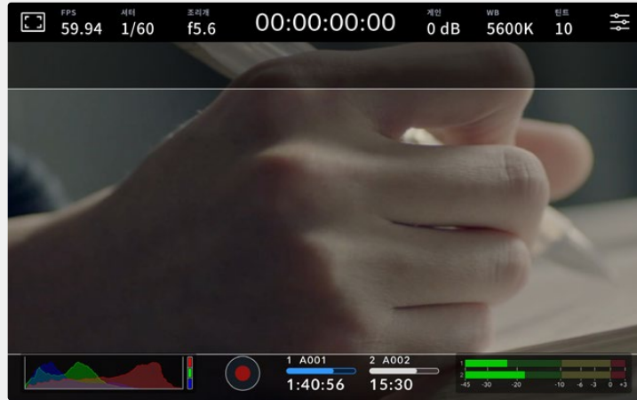
2.40:1 프레임 가이드가 적용된 LCD 터치스크린의 모습
