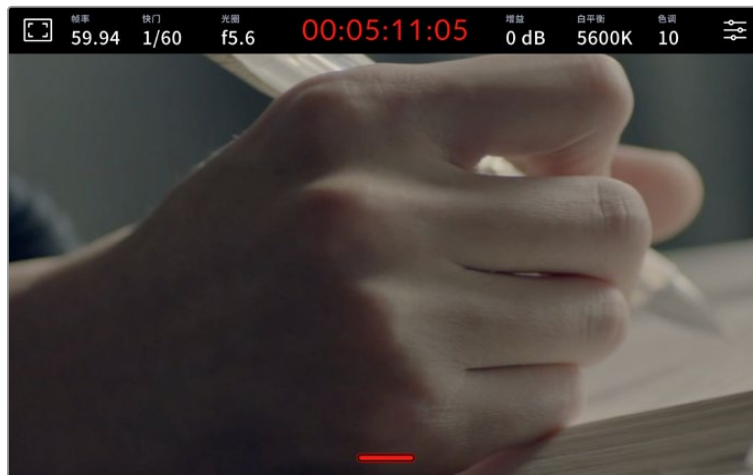
在LCD触摸屏上向上或向下滑动隐藏下横栏叠加。
