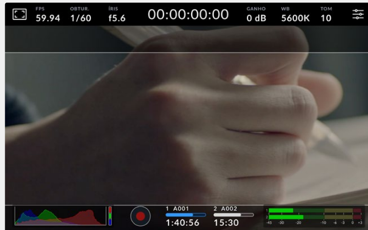
Tela de toque LCD com guias de enquadramento 2.40:1 habilitadas.
