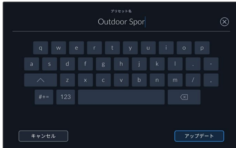
「プリセット (PRESETS)」タブで「追加」アイコンをタップして、タッチキーボードでプリセット名を入力
