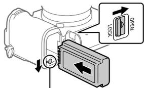
Нажав рычажок фиксатора, вставьте аккумулятор.
