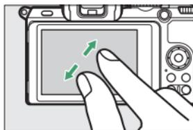
Для перехода в режим просмотра уменьшенных снимков из режима полнокадрового просмотра используйте жест сжатия. Жесты растяжения или сжатия можно использовать для выбора количества кадров (4, 9 или 72 кадра)
