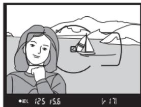
спусковая кнопка затвора нажата наполовину (AF-S) или нажата кнопка  $\text{AE-L/AF-L}$  (2), что позволяет сделать последовательно несколько фотографий при одинаковой настройке фокусировки.
