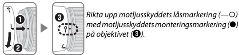
Vid montering och borttagning av skyddet, håll i det längst ner vid -symbolen och undvik att hålla i det för hårt. Om skyddet inte är korrekt monterat kan vinjettering inträffa.
