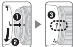
Zarovnajte značku aretovanej polohy slnečnej clony objektívu (—O) s upevňovacou značkou slnečnej clony objektívu (●) na objektíve (3).
