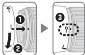
Alinee la marca de bloqueo del parasol (—○) con la marca de montaje del parasol (●) en el objetivo (③).
