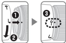
Richten Sie die Markierung für die Arretierung der Gegenlichtblende (—○) an der objektivseitigen Markierung für das Ansetzen der Gegenlichtblende (●) aus (3).
