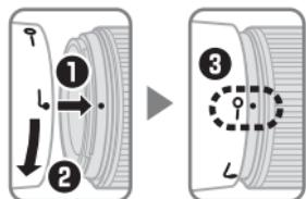
Lijn de vergrendelmarkering op de zonnekap (—○) uit met bevestigingsmarkering voor de zonnekap (●) op het objectief (3).
