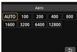
Если для чувствительности ISO задано значение **[AUTO]**, при наполовину нажатой кнопке спуска затвора отображается фактическое значение чувствительности ISO. Как указано ниже, чувствительность ISO автоматически устанавливается в соответствии с режимом съемки.
