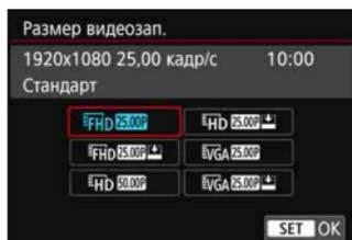
С помощью параметра [ **2:Размер видеозап.** ] можно задать параметры видеозаписи (размер изображения, частоту кадров и метод сжатия данных).
