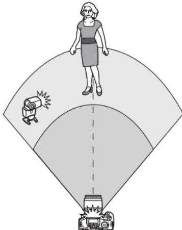
Здесь описывается полностью автоматическая съемка с одной внешней беспроводной вспышкой Speedlite и встроенной вспышкой. Можно изменить соотношение мощностей внешней вспышки Speedlite и встроенной вспышки для желаемой подсветки теней. На экранах меню значки <≡☑> и <☑> обозначают внешнюю вспышку Speedlite, а значки <☑☑> и <☑> обозначают встроенную вспышку.
