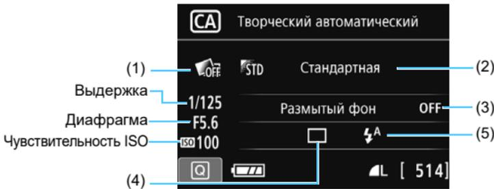
Если установить в камере параметр (1), (2) или (3) при съемке в режиме Live View, то перед съемкой можно посмотреть эффект на экране.
