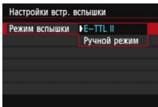
Обычно устанавливайте значение [E-TTL II]. Это дает возможность съемки с автоэкспозицией с помощью встроенной вспышки.
