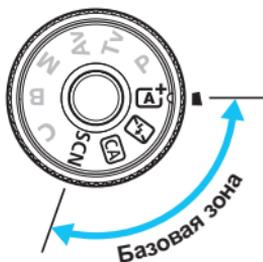
Если при выключенном ЖК-дисплее диск установки режима находится в положении <SCN>, нажмите кнопку <Q> (стр. 81) или <INFO.> (стр. 394), чтобы проверить перед съемкой, какой режим съемки был установлен.
