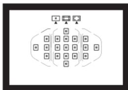
Съемка в режимах автофокусировки с использованием 19 точек автофокусировки в видоискателе подходит для самых различных объектов и сюжетов.
