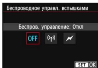
Съемка с беспроводной вспышкой (несколько вспышек) возможна при помощи радио или оптической передачи. См. подробнее в инструкции по эксплуатации вспышки Speedlite, совместимой с функцией съемки с беспроводной вспышкой.
