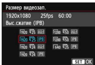
В меню [ **2: Размер видеозап.** ] можно задать размер видеоизображения, количество записываемых в секунду кадров (скорость видеозаписи) и метод сжатия данных. Скорость видеозаписи автоматически переключается в зависимости от значения, заданного для параметра [ **3: ТВ-стандарт** ].
