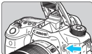
В режимах творческой зоны для съемки с использованием встроенной вспышки поднимите ее, нажав кнопку **<⚡>**. Возврат вспышки в исходное положение выполняется нажатием пальцев. В режимах базовой зоны (кроме режимов **<P>** **<Tv>** **<Av>** **<M>**)
