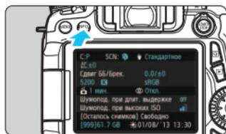
Когда камера готова к съемке, нажав кнопку <INFO.>, можно отобразить параметры [Отображ. настройки фотоапп.], [Электронный уровень] (стр. 65), и [Отображ. функций съёмки] (стр. 395).
