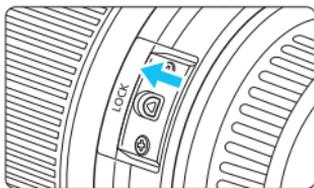
Можно предотвратить выдвигание объектива во время его переноски. Установите кольцо зумирования в широкоугольное положение 18 мм, затем передвиньте рычаг фиксатора кольца зумирования в положение <LOCK>. Кольцо зумирования можно зафиксировать только в широкоугольном положении.
