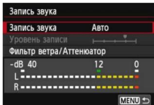
Запись звука во время видеосъемки возможна с помощью встроенного или приобретенного отдельно стереофонического микрофона. Также можно свободно регулировать уровень записи звука. Задайте значения для функции записи звука на вкладке [Ср. 2: Запись звука].
