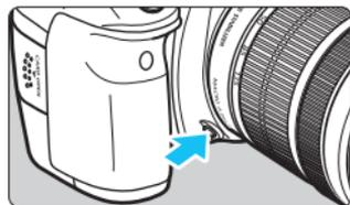
Нажав кнопку предварительного просмотра глубины резкости, можно привести диафрагму объектива в соответствие с текущей установкой и проверить глубину резкости (диапазон приемлемой фокусировки).
