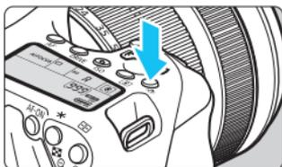
Включите (☀)/выключите подсветку панели ЖКД нажатием кнопки <☀>. В режиме ручной длительной выдержки полное нажатие кнопки спуска затвора приводит к отключению подсветки панели ЖКД.
