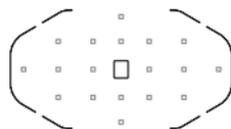
В режиме AI Servo AF (следающая автофокусировка) выбранная вручную (стр. 105) точка автофокусировки <□> используется для наводки на резкость в первую очередь. Точки автофокусировки, где обеспечена наводка на резкость, отображаются как <□>.
