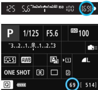
В правой нижней области видоискателя и на экране настроек функций съемки отображается соответствующая максимальная длина серии.
