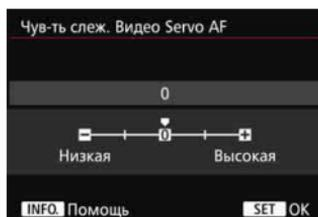
Вы можете изменить чувствительность слежения Видео Servo AF, выбрав один из пяти уровней. Эта настройка влияет на время отклика чувствительности слежения автофокусировки, когда точка AF теряет объект съемки, например при панорамировании или возникновении препятствий. Эта функция доступна, когда для режима [Видео Servo AF] выбрано значение [Включить], а для параметра [Метод AF] выбрано значение [FlexiZone - Single].
