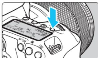
Включите (☀) или выключите подсветку ЖК-панели нажатием кнопки <☀>. В режиме ручной длительной выдержки полное нажатие кнопки спуска затвора приводит к отключению подсветки ЖК-панели.
