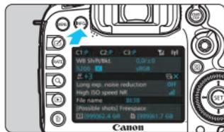
Если камера готова к съемке, нажав кнопку <INFO.>, можно последовательно отобразить параметры [Отображ. настройки фотоапп.], [Электронный уровень] (стр. 75), и [Отображ. функций съёмки] (стр. 469).
