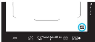
При нажатии кнопки спуска затвора наполовину и выполнении автофокусировки в правой нижней части видоискателя отображается значок **<AF>**. В режиме Покадровая AF значок также отображается при нажатии кнопки спуска затвора наполовину после того, как фокус достигнут.
