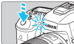
📷 Если при нажатии кнопки спуска затвора вы не будете смотреть в видоискатель, закройте его крышкой окуляра (стр. 247). При попадании в видоискатель света в момент съемки экспозиция может быть нарушена.
