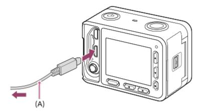
• Если фотокамера подключается к компьютеру кабелем micro USB, когда для параметра [USB Power Supply (Подача питания через USB)] установлена настройка [On (Включено)], питание на камеру подается с компьютера. (Настройка по умолчанию: [On (Включено)])
