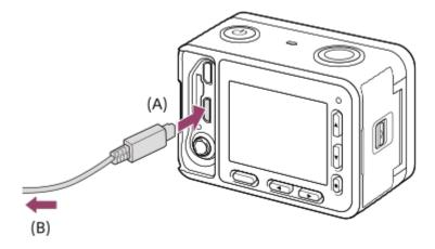
**A:** К гнезду Multi/Micro USB **B:** К гнезду USB на компьютере
