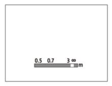
При нажатии кнопок перемещения вверх/вниз фокусное расстояние изменяется фиксированными шагами в последовательности «0,5 м  $\leftrightarrow$  0,7 м  $\leftrightarrow$  3 м  $\leftrightarrow$   $\infty$ ».
