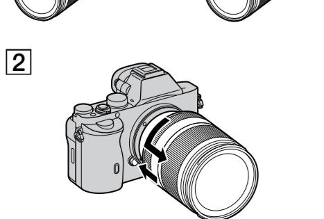
• Передню кришку об'єктива можна прикріпляти/від'єднувати двома способами, (1) та (2). Для прикріплення/від'єднання кришки об'єктива з прикріпленою блендою об'єктива використовуйте спосіб (2).
