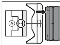
2 朝箭头指示的方向转动镜头遮光罩，以便将镜头遮光罩上的标记②(○)对准镜头顶端的标记。
