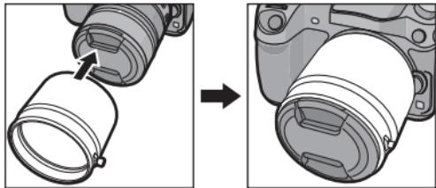
**3 Gire el tornillo de la tapa del objetivo en la dirección de la flecha para asegurar la tapa del objetivo correctamente.**
