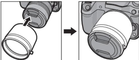
**3 朝箭頭指示的方向轉動鏡頭遮光罩螺絲牢牢地固定住鏡頭遮光罩。**
