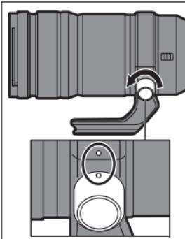
**2** Richten Sie die Markierungen auf der Stativhalterung und dem Verriegelungsknopf der Stativhalterung aufeinander aus.
