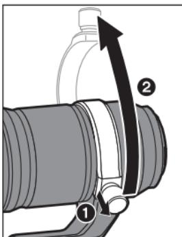
**3** Откройте и снимите крепление для штатива, вытянув ручку блокировки крепления для штатива.
