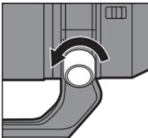
**2** Drehen Sie die Digitalkamera und das Objektiv, um die Ausrichtung zu ändern.
