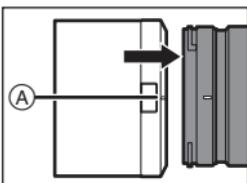
**2 Faites tourner le parasoleil dans le sens de la flèche pour aligner le repère **B** (○) présent sur le parasoleil sur le repère situé à l'extrémité de l'objectif.**
