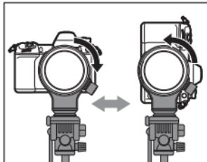
**3** Поверните ручку блокировки крепления для штатива в направлении, указанном стрелкой, чтобы туго затянуть ее.
