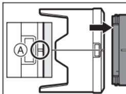
**2 Поверните бленду объектива в направлении, указанном стрелкой, совмещая метку (B) (○) на бленде объектива с меткой на краю объектива.**
