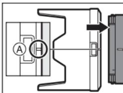
**2** 朝箭头指示的方向转动镜头遮光罩，以便将镜头遮光罩上的标记③(○)对准镜头顶端的标记。
