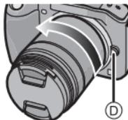
■ **Objektivdeckel aufsetzen und abnehmen**
