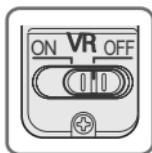
**ON:** Der Effekt von Kameraverwacklungen wird bei Betätigung des Auslösers bis zum ersten Druckpunkt und zum Zeitpunkt des Auslösens verringert. Da die Vibrationen bereits im Sucher verringert werden, gestalten sich automatisches/manuelles Scharfstellen und die exakte Ausrichtung des Motivs einfacher.
