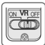
**ON:** Effekterna av kameraskakning reduceras när du trycker ned avtryckaren halvvägs samt vid det ögonblick då bilden tas. Eftersom vibrationer reduceras i sökaren, underlättas den automatiska eller manuella fokuseringen och själva komponeringen av motivet i sökaren blir lättare.
