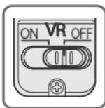
**ON:** De effecten van cameratrillingen worden verminderd wanneer de ontspanknop half wordt ingedrukt en ook op het moment dat de sluiter wordt losgelaten. Omdat de vibratie wordt verminderd in de zoeker, is het eenvoudiger om automatisch/handmatig scherp te stellen en het onderwerp precies te kadreren.
