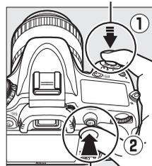
**Режим фокусировки AF-S:** При появлении индикатора фокусировки фокусировка блокируется автоматически и остается в этом состоянии до тех пор, пока со спусковой кнопки затвора не будет убран палец. Фокусировку также можно заблокировать, нажав кнопку  $\text{AE-L/AF-L}$  (AЭ-Б/АФ-Б) (см. выше).
