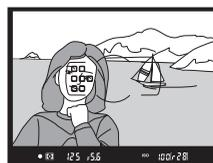
Режим зоны АФ можно выбрать, нажав кнопку режима АФ и поворачивая вспомогательный диск управления до тех пор, пока желаемая настройка не отобразится в видоискателе или на панели управления.
