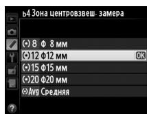
Имейте в виду, что если не выбрано **Средняя**, то при использовании объектива без микропроцессора диаметр зафиксирован на 12 мм, независимо от настройки, выбранной для **Данные объектива без CPU** в меню настройки (☐ 172). При выборе **Средняя** будет использоваться среднее значение для всего кадра, как для объективов с микропроцессором, так и для объективов без микропроцессора.
