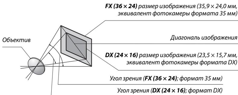
Угол зрения **DX (24 × 16)** примерно в 1,5 раза меньше, чем угол зрения формата 35 мм. Чтобы высчитать фокусное расстояние объективов формата 35 мм, когда выбрано **DX (24 × 16)**, умножьте фокусное расстояние объектива примерно на 1,5 (например, эффективное фокусное расстояние 50 мм объектива в формате 35 мм будет 75 мм, когда выбрано **DX (24 × 16)**).
