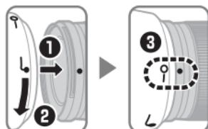
*Alinhe a marca de bloqueio do pára-sol da objectiva (—○) com a marca de montagem do pára-sol da objectiva (●) na objectiva (3).*
