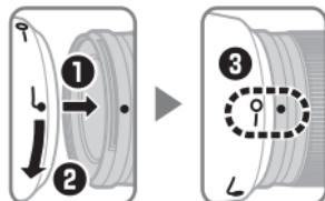
Zarovnajte značku aretovanej polohy slnečnej clony objektívu (—○) s upevňovacou značkou slnečnej clony objektívu (●) na objektíve (3).
