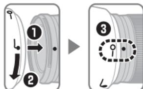
*Richten Sie die Markierung für die Arretierung der Gegenlichtblende (—○) an der objektivseitigen Markierung für das Ansetzen der Gegenlichtblende (●) aus (3).*
