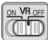
**ON:** De effecten van cameratrillingen worden verminderd wanneer de ontspanknop half wordt ingedrukt en ook op het moment dat de sluitser wordt losgelaten. Omdat de vibratie wordt verminderd in de zoeker, is het eenvoudiger om automatisch/handmatig scherp te stellen en het onderwerp precies te kaderen.
