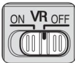
**ON:** 在半按快门释放按钮时，以及在释放快门的瞬间，会减少照相机震动的影响。因为在取景器中减震，自动/手动对焦和对拍摄对象的精确构图将更加容易。
