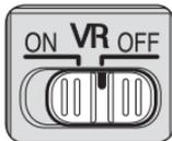
**ON:** Effekterna av kameraskakning reduceras när du trycker ned avtryckaren halvvägs samt vid det ögonblick då bilden tas. Eftersom vibrationer reduceras i sökaren, underlättas den automatiska eller manuella fokuseringen och själva komponeringen av motivet i sökaren blir lättare.
