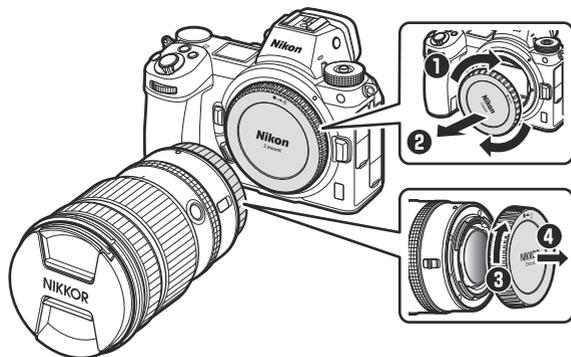
2. Установите объектив на корпус фотокамеры, совместив метки крепления на объективе и корпусе фотокамеры (1), а затем поверните объектив против часовой стрелки (2) до щелчка.
