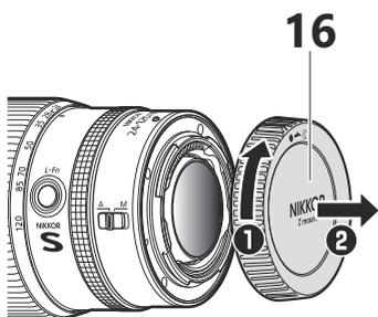
**16 Крышка объектива (задняя защитная крышка)**
