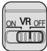
**ON:** 在半按快门释放按钮时，以及在释放快门的瞬间，会减少照相机震动的影响。因为在取景器中减震，自动/手动对焦和对拍摄对象的精确构图将更加容易。
