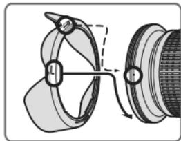
将遮光罩上的镜头遮光罩上对齐标志①，两个标记中的任何一个标记) ②对准镜头上的镜头上对齐标志④，然后逆时针方向转
