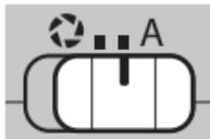
Aby ustawić przysłonę ręcznie, przesuń przełącznik na **S**, a następnie obracaj pierścień przysłony. Obróć pierścień w lewo, aby rozszerzyć przysłonę (niższa liczba f), a w prawo, aby zmniejszyć przysłonę (wyższa liczba f).
