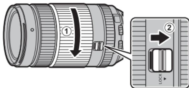
① Déverrouillez le commutateur avant d'utiliser la bague de zoom.
