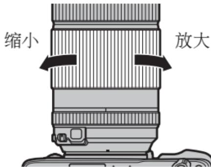
① 若镜头被弄湿，使用变焦环可使镜头内部的水分更容易流出。使用变焦环之前，请先擦干镜头上的所有水分。
