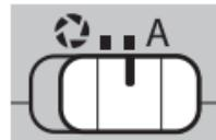
För manuell justering av bländaren, skjut lägesvälvjaren till **⌚** och vrid bländarringen. Vrid ringen åt vänster för större bländaröppning (lägre f-nummer), och till höger för mindre bländaröppning (högre f-nummer).
