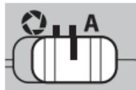
絞りをマニュアル設定にしたいときは、絞りモードスイッチを**S**の位置に合わせます。絞りリングを反時計回り方向に回すと絞りが開き、時計回り方向に回すと絞りが絞り込みます。
