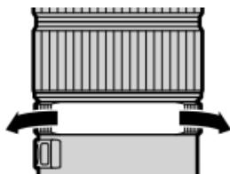
ادر حلقة التحكم في الزوم/التركيز البؤري للتكبير أو التصغير باستخدام الزوم الكهربائي. تتناسب سرعة الزوم مع السرعة التي يتم بها تدوير الحلقة.
