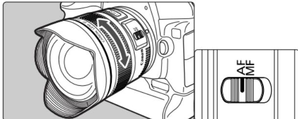
Для съемки в режиме автоматической фокусировки установите переключатель режимов фокусировки в положение AF.
