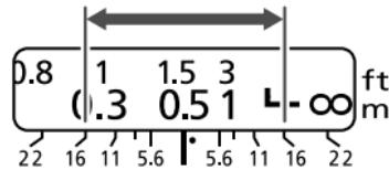
Глубина резкости – это диапазон пространства (расстояния) спереди и сзади плоскости фокуса на объекте, которое изображается резким. Глубина резкости обозначается зоной между линиями на шкале глубины резкости под шкалой расстояний. Цифры на шкале представляют собой значения F, и, например, при съемочном расстоянии 0,5 м и диафрагме f/16 зона пространства в фокусе составит диапазон от приблизительно 0,3 м до бесконечности.
