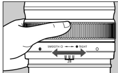
Вы можете настроить нужное “усиление”, требуемое для настройки масштабирования, (сила сопротивления на трансфокаторе), поворачивая кольцо регулировки и удерживая при этом кольцо фокусировки на месте.
