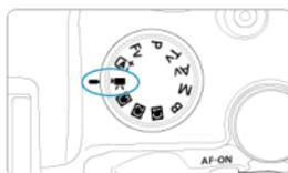
Для видеосъемки поверните диск установки режима в положение **< V >**.
