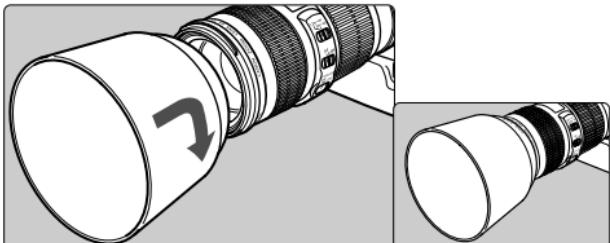
Бленда ET-74 не допускает нежелательные блики и свет на линзы объектива, а также защищает объектив от попадания на поверхность линзы дождя, снега и пыли. Подсоедините и выровняйте бленду на креплении бленды в передней части объектива, затем поверните бленду, как это указано стрелкой, чтобы надежно закрепить ее. При хранении объектива можно закрепить бленду на объективе в обратной ориентации.
