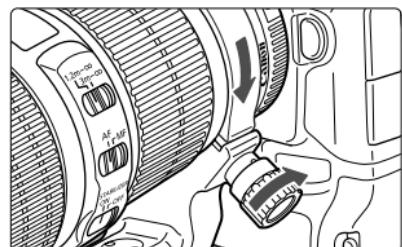
**1** Поверните винт замка против часовой стрелки, чтобы его ослабить (около 3 поворотов), затем потяните винт в направлении, указанном стрелкой, чтобы расцепить воротник штативной пятки.
