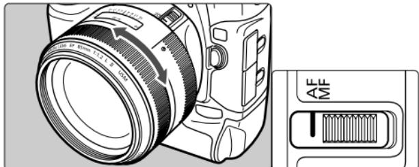
Для съемки в режиме автоматической фокусировки (AF) установите переключатель режимов фокусировки в положение AF. Чтобы использовать ручную фокусировку (MF), установите переключатель режимов фокусировки в положение MF и настройте фокусировку, поворачивая фокусировочное кольцо.
