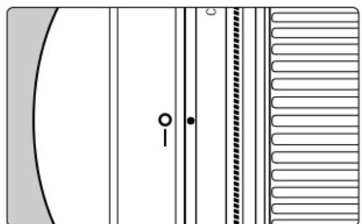
Чтобы подсоединить бленду, выровняйте метку позиции подсоединения на бленде по красной точке на передней части объектива, затем поверните бленду в направлении, как это указано стрелкой, таким образом, чтобы красная точка на объективе совместилась с меткой фиксации бленды в креплении.
