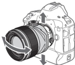
Положение механизма наклона, при котором направления наклона и сдвига перпендикулярны
