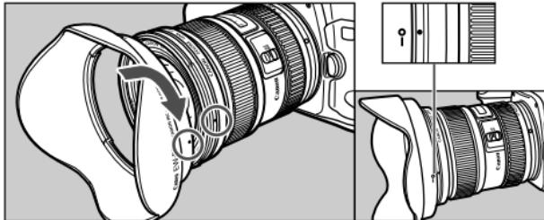
Бленда EW-83E не допускает нежелательные блики и свет на линзы объектива, а также защищает объектив от попадания на поверхность линзы дождя, снега и пыли.
