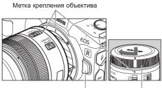
Кнопка разблокировки объектива Пылезащитная крышка
