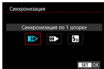
Обычно для этого параметра задается значение **[Синхронизация по 1 шторке]**, чтобы вспышка сработывала сразу после начала съемки.
