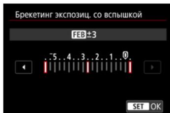
Вспышки Speedlite с функцией брекетинга экспозиции со вспышкой (FEB) могут автоматически изменять мощность внешней вспышки при съемке трех кадров подряд.
