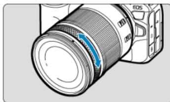
По умолчанию компенсацию экспозиции можно задавать, поворачивая кольцо управления на объективе RF или адаптерах для крепления при наполовину нажатой кнопке спуска затвора в режиме <Fv>, <P>, <Tv>, <Av> или <M>. Можно также назначить кольцу управления другую функцию, выполнив настройки в пункте [☰]: **Назначить диски управления** (☑).
