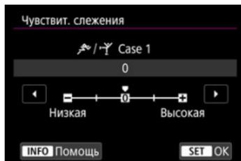
Настройка чувствительности отслеживания объектов в режиме Следящая автофокусировка (Servo AF) при перемещении препятствий через точки AF или при выходе объектов из точек AF.
