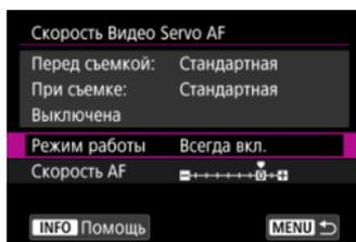
Можно задать значение **[Всегда вкл.]**, чтобы скорость AF всегда использовалась при видеосъемке (до и во время видеосъемки) или значение **[Во время съемки]**, чтобы скорость AF использовалась только во время видеосъемки.
