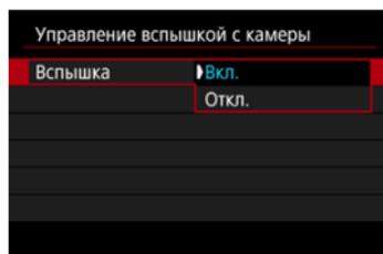
Для подключения возможности съемки со вспышкой задайте значение **[Вкл.]**. Чтобы включить только лампу помощи AF вспышки Speedlite, задайте значение **[Откл.]**.
