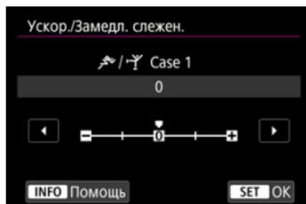
Настройка чувствительности отслеживания объектов в случае внезапных значительных изменений их скорости, а также в случае внезапного начала движения или остановки объектов.
