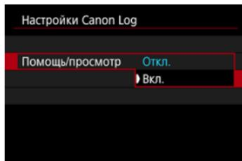
Из-за характеристик изображения Canon Log, которые предназначены для обеспечения широкого динамического диапазона, при воспроизведении в камере эти видеозаписи выглядят темными и имеют более низкий контраст, чем видеозаписи, записанные с примененным стилем изображения. Для четкого отображения, упрощающего проверку деталей, задайте для параметра **[Помощь/просмотр]** значение **[Вкл.]**.
