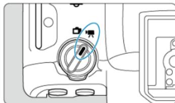
Для записи видео установите переключатель съемки фотографий/записи видео в положение < [📹] >.
