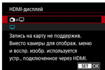
Можно указать, как отображаются видеозаписи при записи по интерфейсу HDMI на внешнее устройство. Сам выходной видеосигнал соответствует настройке **[Парам. видеозап.]**.
