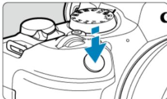
Этим нажатием активизируется функция автофокусировки и система автоэкспозиции, которая устанавливает выдержку и значение диафрагмы. Величина экспозиции (выдержка и значение диафрагмы) отображается на экране или в видоискателе в течение 8 с (таймер замера/8).
