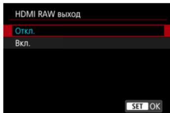
Установите значение **[Вкл.]** для вывода видеосигнала RAW с разрешением до 6К с разъема HDMI на совместимые устройства.
