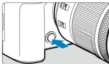
Нажав кнопку предварительного просмотра глубины резкости, можно привести значение диафрагмы объектива в соответствие с текущей установкой и проверить область, находящуюся в фокусе (глубину резкости).
