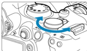
Следя за индикацией на экране или в видеоскатель, поворачивайте диск <
