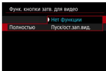
Если для пункта [**Полностью**] задано значение [**Пуск/ост.зап.вид.**], запускать и останавливать видеосъемку можно не только с помощью кнопки видеосъемки, но и полным нажатием кнопки спуска затвора или с помощью пульта RS-60E3 (продается отдельно).
