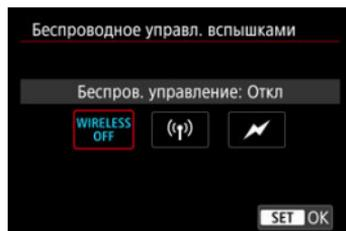
Можно использовать беспроводную радиопередачу или оптическую передачу для беспроводной съемки с несколькими вспышками. Подробнее см. в инструкции по эксплуатации вспышки Speedlite, поддерживающей функцию фотосъемки с беспроводной вспышкой.
