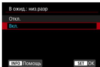
Задайте значение **[Вкл.]**, чтобы экономить заряд аккумулятора и контролировать рост температуры внутри камеры в режиме ожидания.
