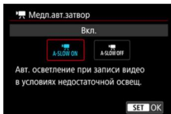
Можно выбрать, требуется ли снимать более яркие видеофильмы, меньше подверженные шумам, чем при значении [Откл.], за счет автоматического увеличения выдержки затвора при низкой освещенности.
