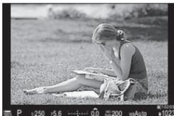
Видоискатель включается автоматически при приближении к нему глаз пользователя. Когда включается видоискатель, монитор отключается.
