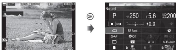
Данный раздел описывает использование панели управления super/LV super на примере функции [Опред. лица и глаз].
